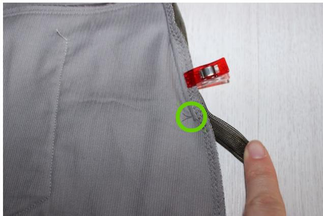
Klappe das Ende des Reißverschlusses zur Seite und beginne die Naht genau an dem Punkt, an dem die Naht mit der der Reißverschluss eingenäht wurde, endet.
