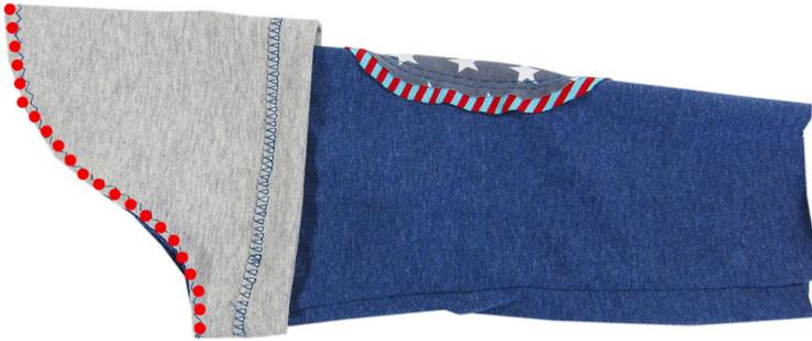
Kurze Ärmel **links** auf **rechts** auf den inneren langen Ärmel ziehen, die Unterarmnähte liegen genau übereinander. KURZEN und langen Ärmel an der Armkugel mit einer dehnbaren Naht knapp aufeinander fixieren.
