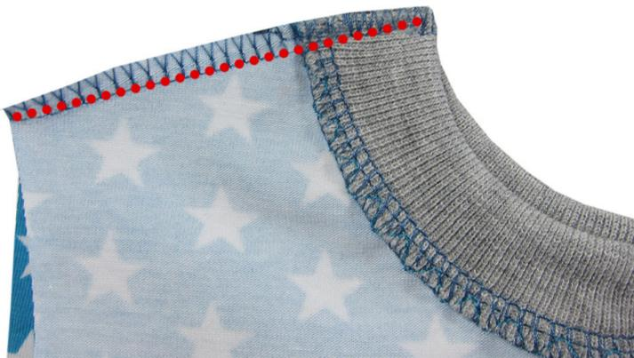
Zweite Schulternaht rechts auf rechts legen und schließen.
