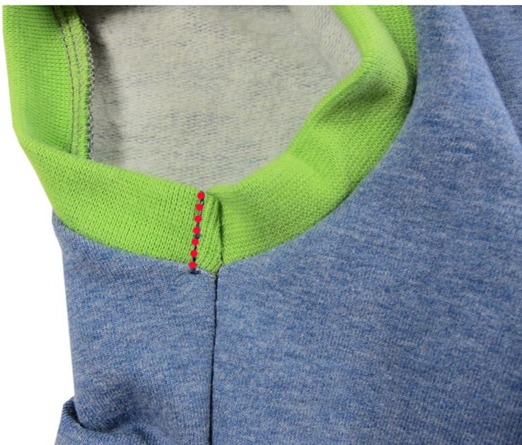
Nahtzugaben unter den Ärmeln in eine Richtung klappen und mit einer kurzen Naht feststeppen.
