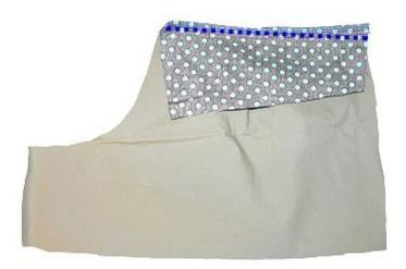
An den Hinterhosenteilen die kleinen Falten markierungsgemäß rechts auf rechts falten und stecken. Falten von rechts knappkantig feststeppen.
